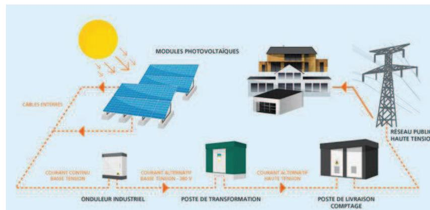
Figure 57 : Produire de l'électricité grâce à l'énergie solaire
