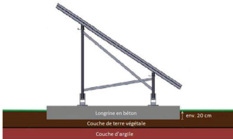
Figure 62 : Exemple de positionnement de longrine en béton par décaissement
